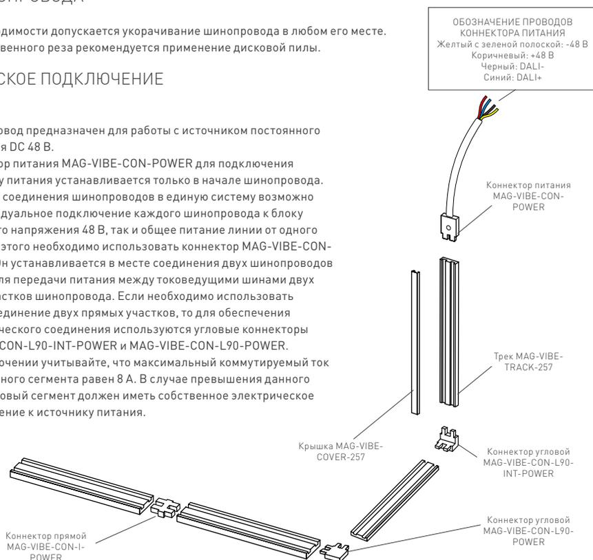
Рис. 2. Элементы и принцип построения разветвленной системы
